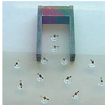
Abb. 1a und b: Veranschaulichung des Magnetfeldes durch kleine Magnetnadeln
