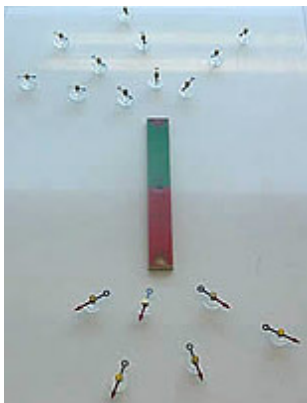
Abb. 1a und b: Veranschaulichung des Magnetfeldes durch kleine Magnetnadeln
