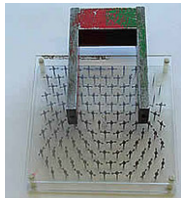
Abb. 2: Veranschaulichung des Magnetfeldes eines Stabmagneten (2a) und eines Hufeisenmagneten (2b) durch kleine Magnetnadeln
