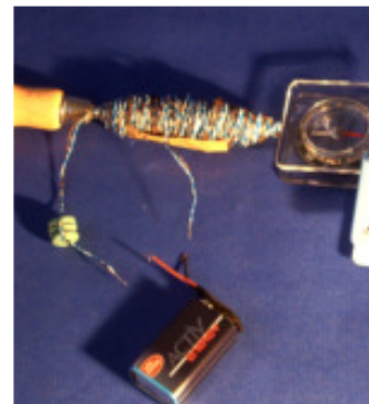
Ummagnetisierung durch kurzen Stromstoß (es reichen Sekundenbruchteile des Stromflusses)
