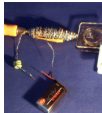
Berührung der Batterieanschlüsse – ein kurzer Stromstoß fließt durch die Spule
