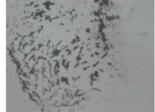
Eisenfeilspäne magnetisiert, sie bilden aufgrund der Anziehung Klumpen
