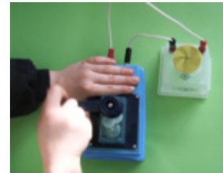
Generator betreibt Motor
