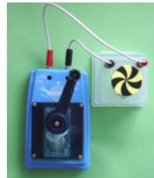
Generator und Motor
