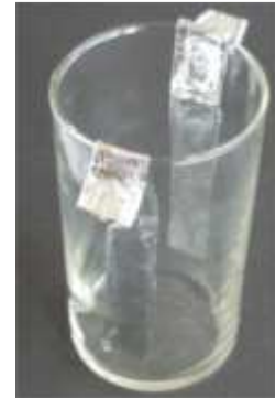
Glas mit Aluminiumfolie als Elektroden
