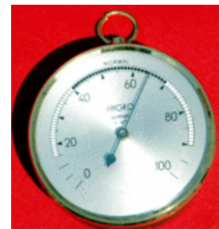
Ein analog messendes Hygrometer
