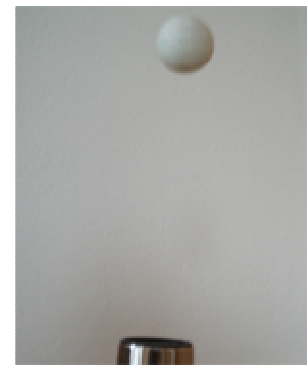
Auch bei stärkerer Föhnleistung bleibt der Ball im Luftstrom "gefangen".
