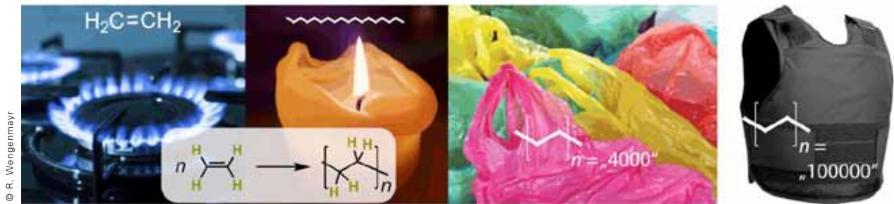
Abb. A: Die Länge der Polymerketten bestimmt die Eigenschaften des Materials
