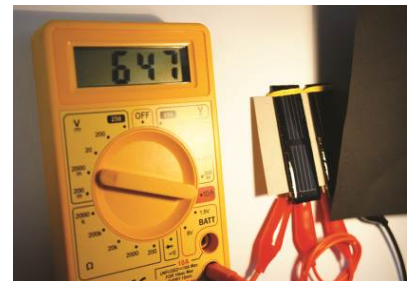
Abb. 13: Teilweise Abschattung einer der beiden Solarzellen.
