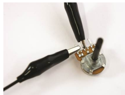
Abb. 17: Anschluss am Potentiometer über einen seitlichen Kontakt und den mittleren Kontakt.
