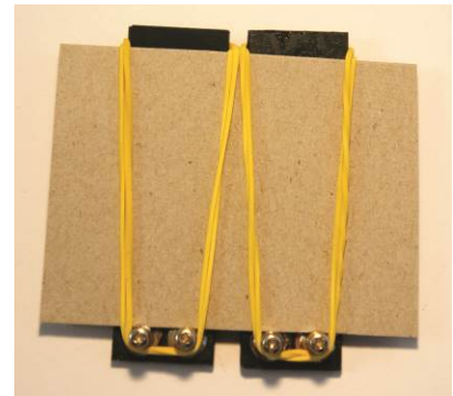
Abb. 6: Montage der Solarzellen auf einen Pappstreifen.
