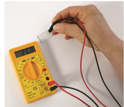
Abb. 2: An der klaren, transparenten Glasplatte wird die leitfähige Seite durch Widerstandsmessung ermittelt.
