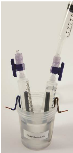
Abb. 17: Absaugen der restlichen Luft, die Zylinder füllen sich mit Sodalösung.
