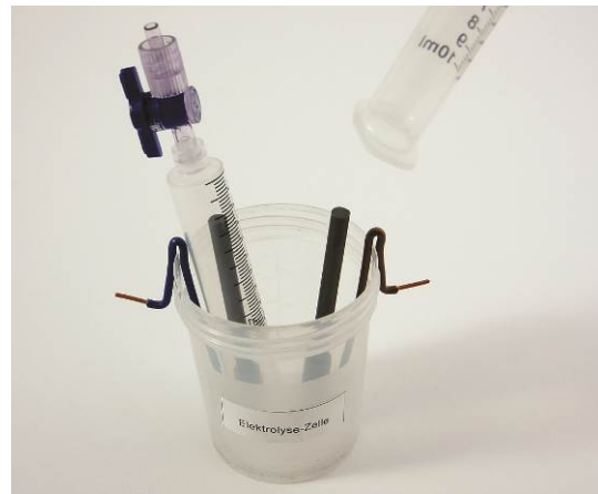
Abb. 16: Endmontage der Zelle.
