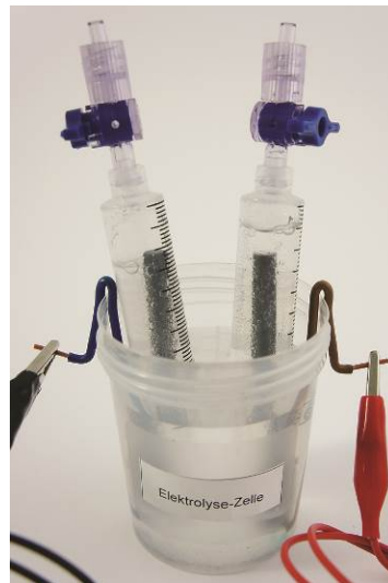
Abb. 18: Die Erzeugung von Gas nach Anschluss des Akkus.
