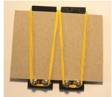
Abb. 4: Montage der Solarzellen auf einen Pappstreifen mittels Gummiband.
