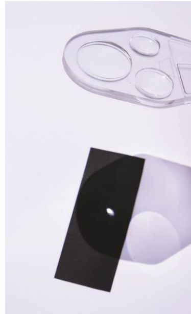
Abb. 2: Erzeugen des Brennpunkts und Entzünden des Papierstreifens.
