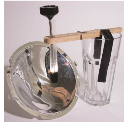
Abb. 4: Klebeband und großes, schweres Trinkglas als Stativersatz.
