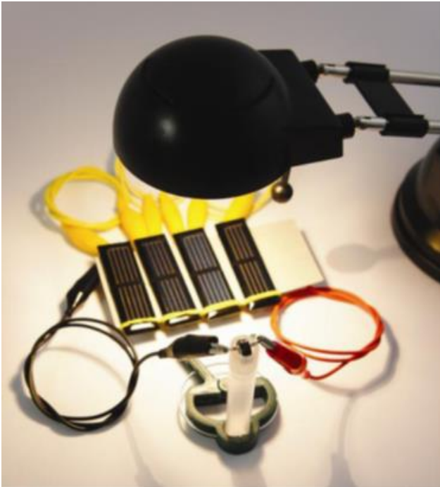
Abbildung 4: Der Kondensator muss nun für ca. 1 Minute geladen werden. Sorgt hierbei unbedingt für eine gute Beleuchtung der Solarzellen.
