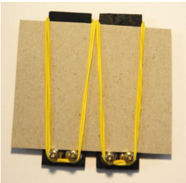
Abbildung 2: Befestigt die Solarzellen mithilfe von Gummis an einem Pappkarton.
