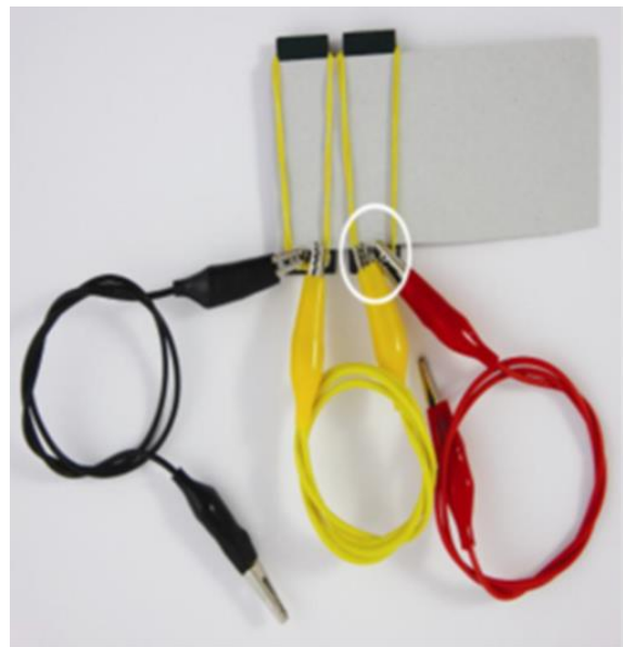
Abbildung 3: Die Solarzellen müssen in Reihe geschaltet werden (Pluspol-Minuspol-Pluspol).
