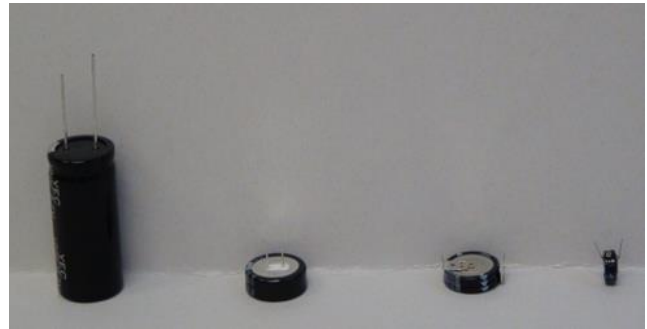
Abbildung 2: Achtet bei den Kondensatoren unbedingt auf die richtige Polung. Der Plus- und der Minuspol sind auf jedem Kondensator markiert.
