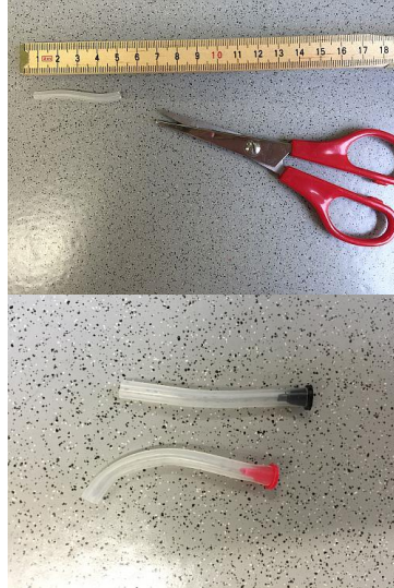
Abbildung 2 und 3: Schneidet zwei Stücke mit einer Länge von je 4 cm vom Gummischlauch ab und steckt einen roten und einen schwarzen Verschluss in jeden Schlauch.
