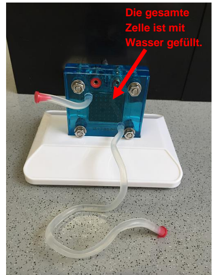
Abbildung 7: Vergleicht den Wasserstand mit der Abbildung. Ist die Zelle vollständig gefüllt, benötigt ihr einen roten Verschluss für den Befüllschlauch.
