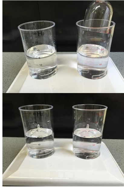
Abbildung 9 und 10: Befestigt die beiden „kuppelförmigen“ Behälter im Inneren der Zylinder. Sollte der Wasserstand nicht mehr auf der „0“-Markierung sein, entfernt ihr etwas Wasser mit der Spritze, bis dieser wieder erreicht ist.
