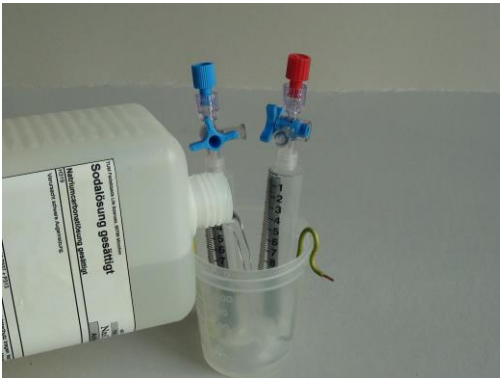
Abb. 4: Befüllt den Kunststoffbecher zu 2/3 mit der Sodalösung. Es ist wichtig, dass die Enden der beiden 10-ml-Spritzen in die Sodalösung eintauchen.
