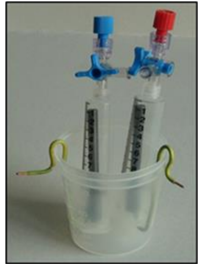
Abb. 3: Die beiden 10-ml-Spritzen werden wie abgebildet auf die Elektroden gesetzt.
