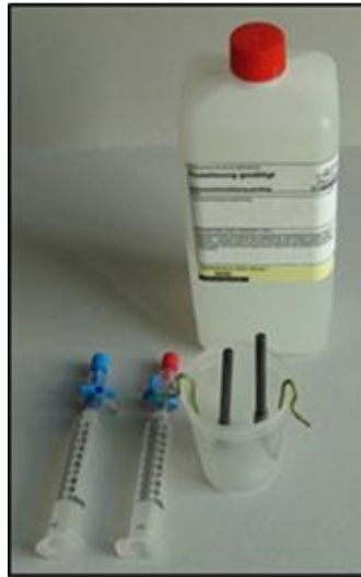
Abb. 2: Die Elektroden werden an dem Kunststoffbecher befestigt.
