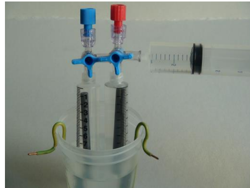
Abb. 5: Nun wird die Sodalösung mithilfe der 20-ml-Spritze in die beiden umgedrehten 10-ml-Spritzen eingesaugt. Die Spritzen im Becher müssen vollständig mit Sodalösung gefüllt werden. Achtet auf die richtige Stellung der Dreiwegehähne. Der Dreiwegehahn muss vor dem Abziehen der Spritze wieder geschlossen werden.
