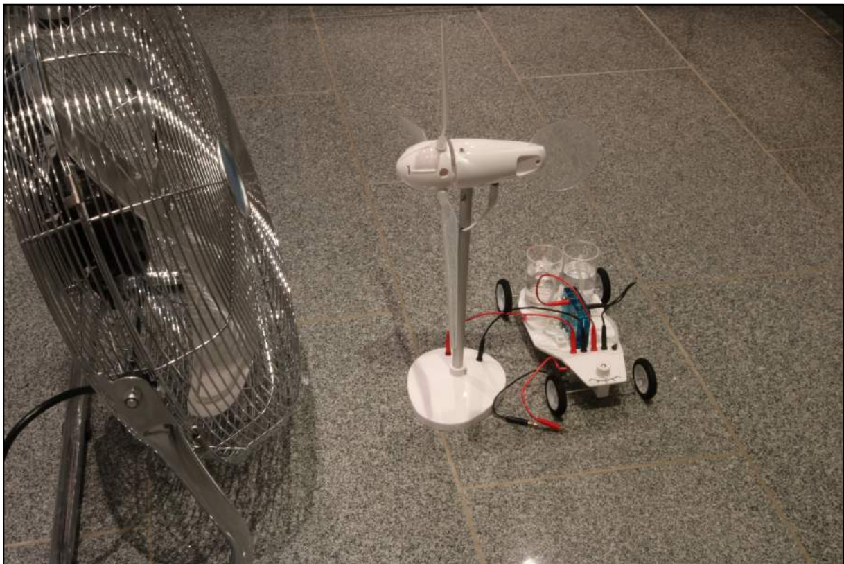
Abbildung C4.01 Elektrolyse von Wasser durch Windenergie mit im Auto integrierter PEM-Brennstoffzelle
