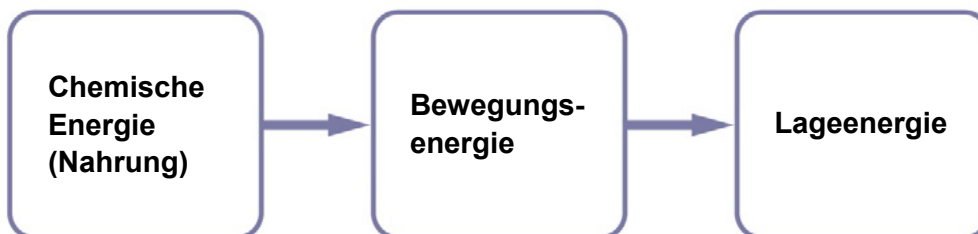
Abb. 5: Vereinfachte Energiewandlungskette beim Bergauffahren mit dem Fahrrad.
