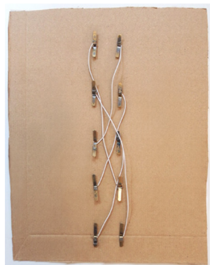
Abbildung 6: Elektroquiz – Rückseite mit Verkabelung.
