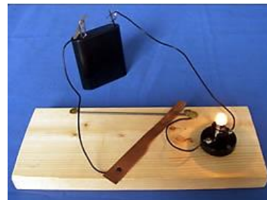
Abb. 3b: 'Dimmer'/viel Licht
