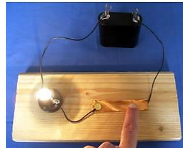
Abb. 2b: 'Druckschalter' geschlossen
