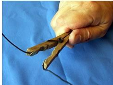
Abb. 4: Schalter gedrückt: Lämpchen leuchtet nicht Schalter losgelassen: Lämpchen leuchtet
