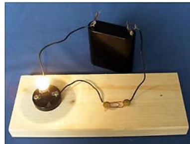
Abb. 1b: 'Drehschalter' geschlossen
