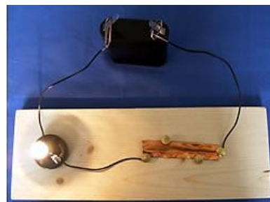
Abb. 1d: 'Schiebeschalter' geschlossen
