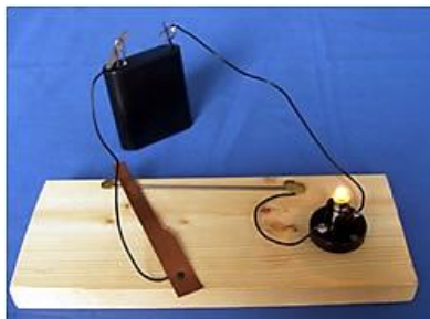
Abb. 3a: 'Dimmer'/wenig Licht (Anwendung: z.B. Beleuchtung)
