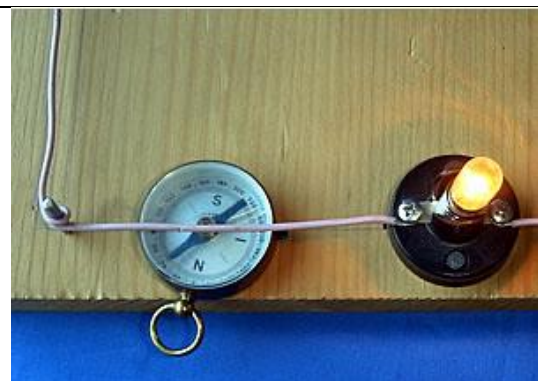
Abb. 4b: Die Magnetnadel schlägt bei geschlossenem Stromkreis aus.
