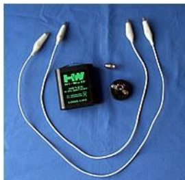
Abb. 6a: Material - Einfacher Stromkreis mit Krokodilklemmen
