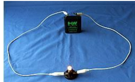
Abb. 6b: Einfacher Stromkreis mit Krokodilklemmen geschlossen
