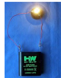
Abb. 1c: Einfacher Stromkreis geschlossen
