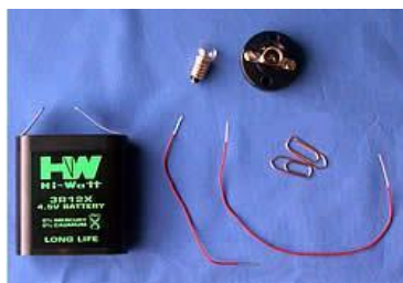
Abb. 1a: Material - Einfacher Stromkreis
