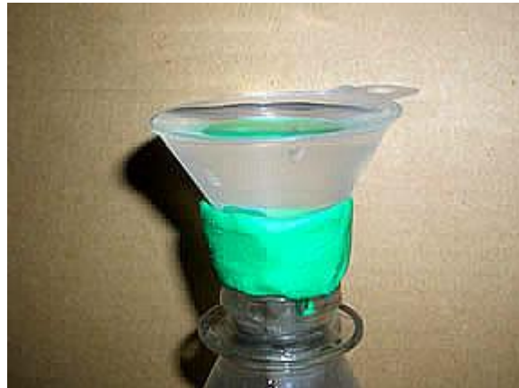
Abb. 2: Wasser kann nicht nachfließen
