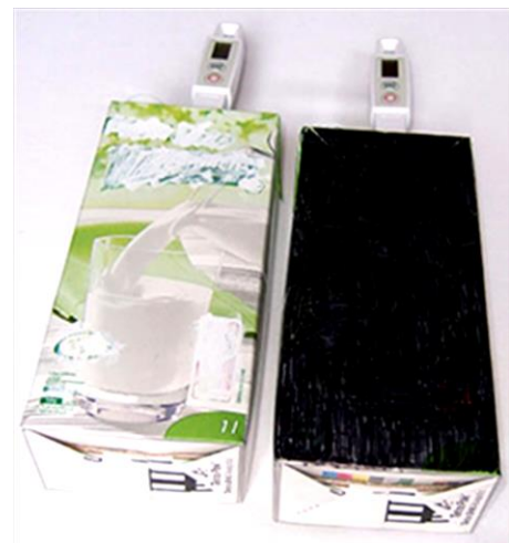
Abb. 3.1: Versuch zur unterschiedlichen Absorption von Strahlung. Die aus den Packungen herausragenden oberen Teile der Thermometer sollten zum Schutz mit einem Stück weißem Papier abgedeckt werden. Oder die Thermometer werden nach der ersten Messung herausgenommen und dann zur zweiten Messung wieder eingesteckt.
