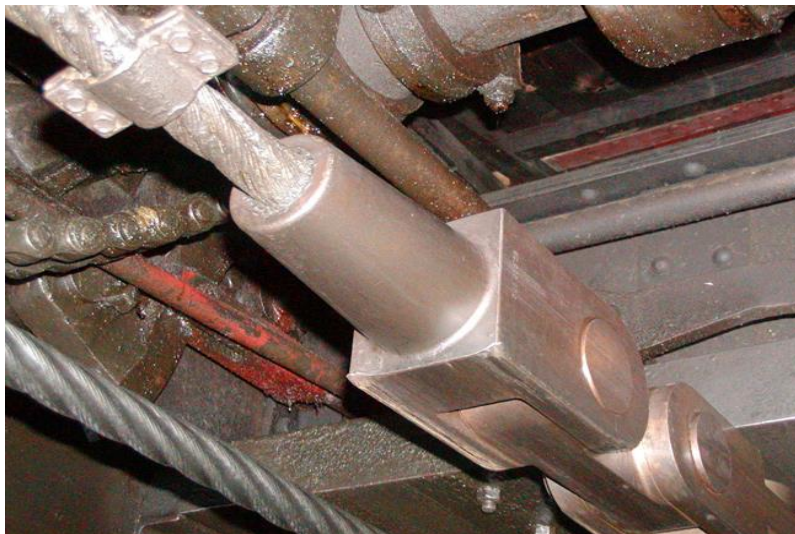
Einbau der Seilkupplung mit dem nachfolgenden Kreuzgelenk (Foto: Prof. Haack)
