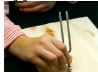
Den Stimmgabelfuß auf Holz halten - das Holz wirkt als Resonanzkörper
