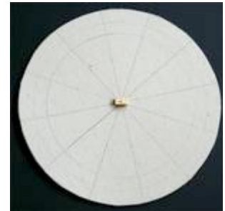
Die Lochkreise und Positionen der Löcher werden mit Zirkel und Winkelmesser vorgezeichnet.
