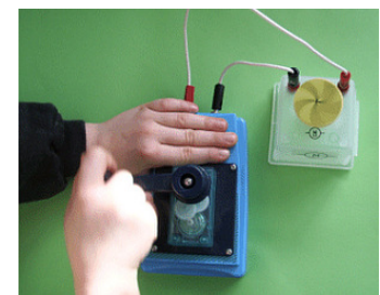
Generator betreibt Motor
