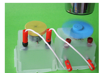
Föhn betreibt Generator, Generator betreibt Motor
