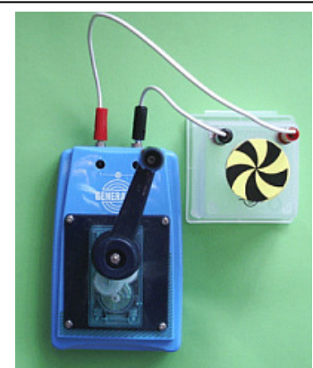
Generator und Motor
