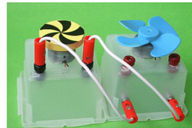
Dreht sich das Windrad, dann arbeitet der Motor als Generator, erzeugt Elektrizität und treibt den Motor im Bild links an.
