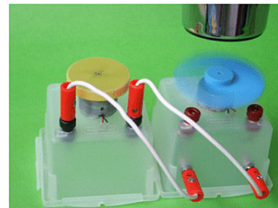
Dreht sich das Windrad, dann arbeitet der Motor als Generator, erzeugt Elektrizität und treibt den Motor im Bild links an.
