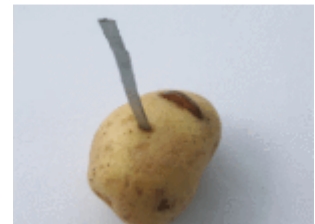
Eine Kartoffel, in die ein Stück Zink und eine Kupfermünze gesteckt wurden.
