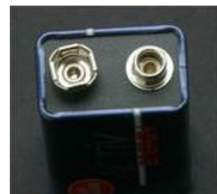
Anschlüsse einer Batterie, die 9 V Spannung liefert.
