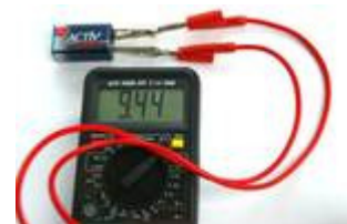
Block-Batterie: Es ist sogar eine etwas höhere Spannung vorhanden.
