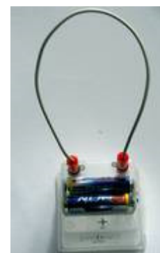
Ein echter Kurzschluss der Batterie
