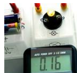
Messung im normalen Stromkreis: 0,16 A (Ampere) Stromstärke
