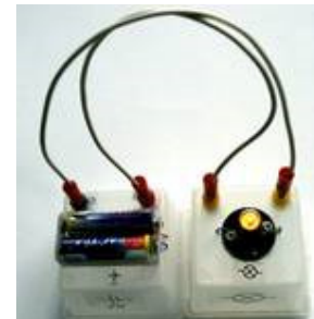
Eine elektrische Schaltung mit Spannungsquelle und Glühlampe
