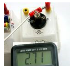
Kurzschluss: 2,71 A Stromstärke, das Mehrfache!
