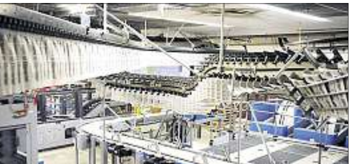
23.15 Uhr: An der Transportkette hängend, laufen die Zeitungen durch die Halle. Die Transportkette nimmt immer eine Zeitung aus der Schuppe. Jede Zeitung hängt dann an einer Klammer und wird von der Druckmaschine in die Erdverarbeitung transportiert.
