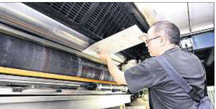
21.45 Uhr: Der Druck der ersten Ausgaben beginnt. Zuvor muss der Drucker Bernd Kriesch die belichteten Platten auf den Zylindern der Druckmaschine anbringen. Auf jeden Zylinder kommt eine Farbe. Oberhalb der Zylinder ist die Papierbahn.
