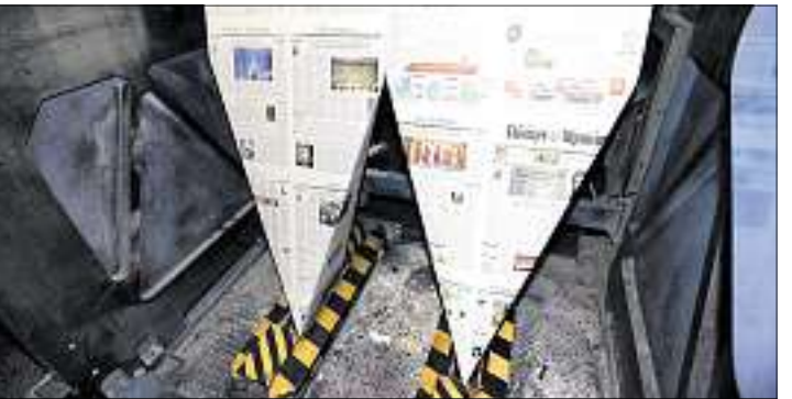
Ab 23 Uhr: Die Hauptausgaben der „Thüringer Allgemeinen“ werden gedruckt. Die Druckerei hat fünf große Druckmaschinen, bis zu 32 000 Exemplare schafft eine in der Stunde. Auf dem Bild bekommt die Zeitung die erste Querfalz.
