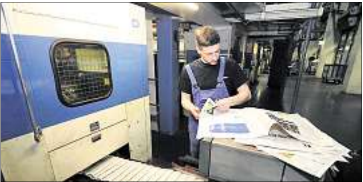
23.10 Uhr: Die ersten Zeitungen kommen im Schuppenstrom fertig gefalzt und geschnitten aus der Druckmaschine. Drucker wie Rico Hellbach verwenden den Ausdruck Schuppenstrom, weil die Zeitungen wie übereinanderstehende Fischschuppen aussehen.
